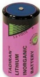
Als de datalogger energiezuinig ontworpen wordt, met een gemiddeld gebruik van minder dan 0,2mA, kan deze batterij 10 jaar lang de elektronica aan het werk houden. Ook kan deze batterij heel goed toegepast worden in draadloze dataloggers die communiceren met GSM of GPRS. In zo'n ontwerp moet wel extra liefdevol omgesprongen worden met de stroomvoorziening, want LTC is niet goed in staat hoge piekstromen te leveren.
